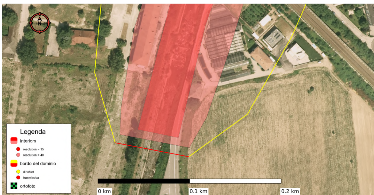
Figura 24: File degli interiors, si veda come è stata evitata la sovrapposizione parziale dei poligoni!
