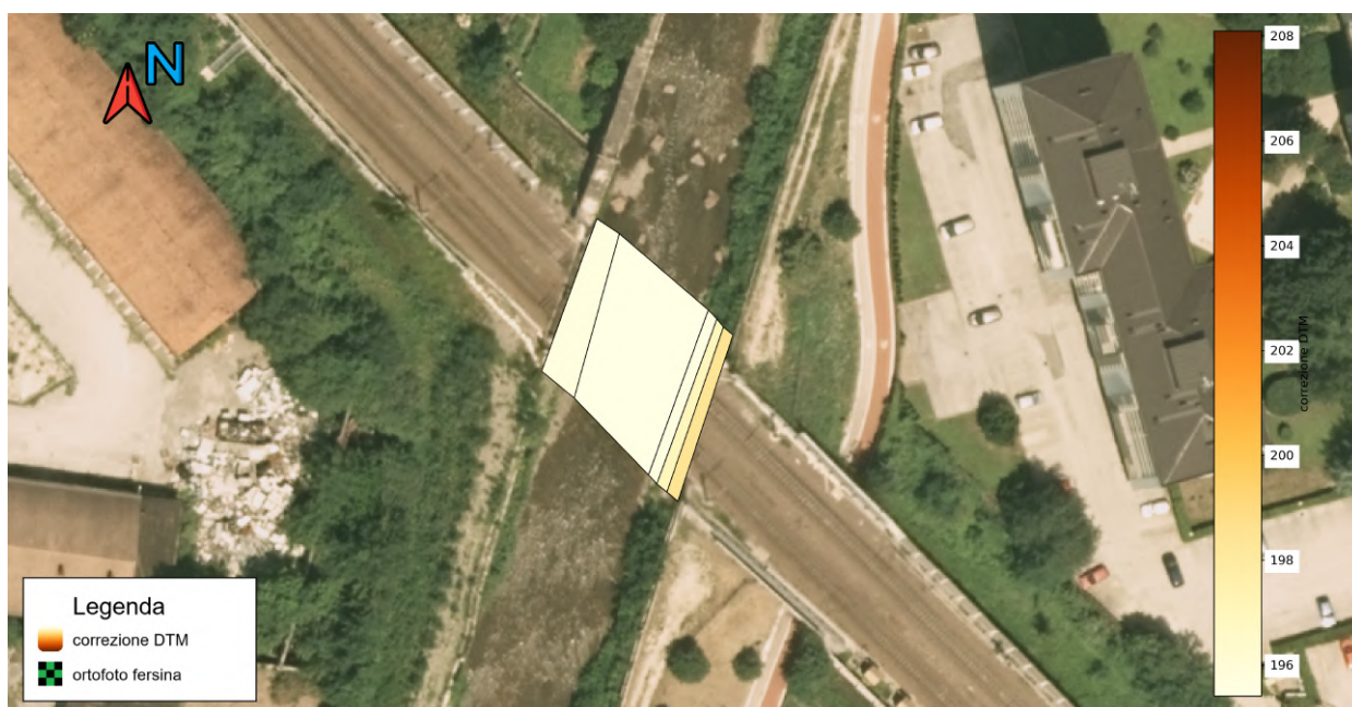
Figura 16: Shapefile utilizzato per la correzione delle quote del Digital Terrain Model, Ponte del Cavalcavia
