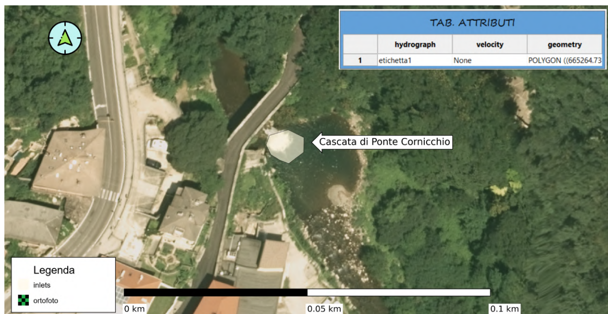
Figura 27: File vettoriale degli inlets. È tracciato un poligono per modellare la cascata. In Figura è riportata anche la tabella degli attributi del vettore
