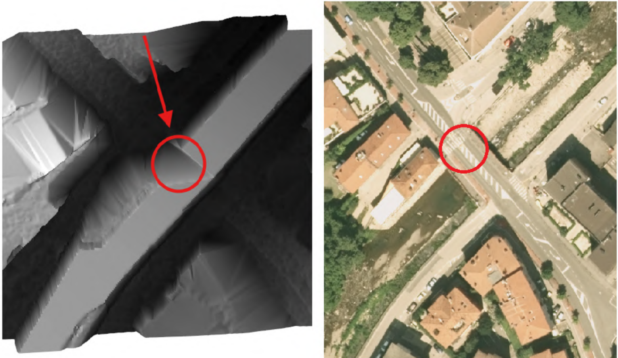
Figura 11: Ponte dei cavalleggeri. A sinistra il grafico 3D delle quote consente di individuare l' errore; a destra l'ortofoto
