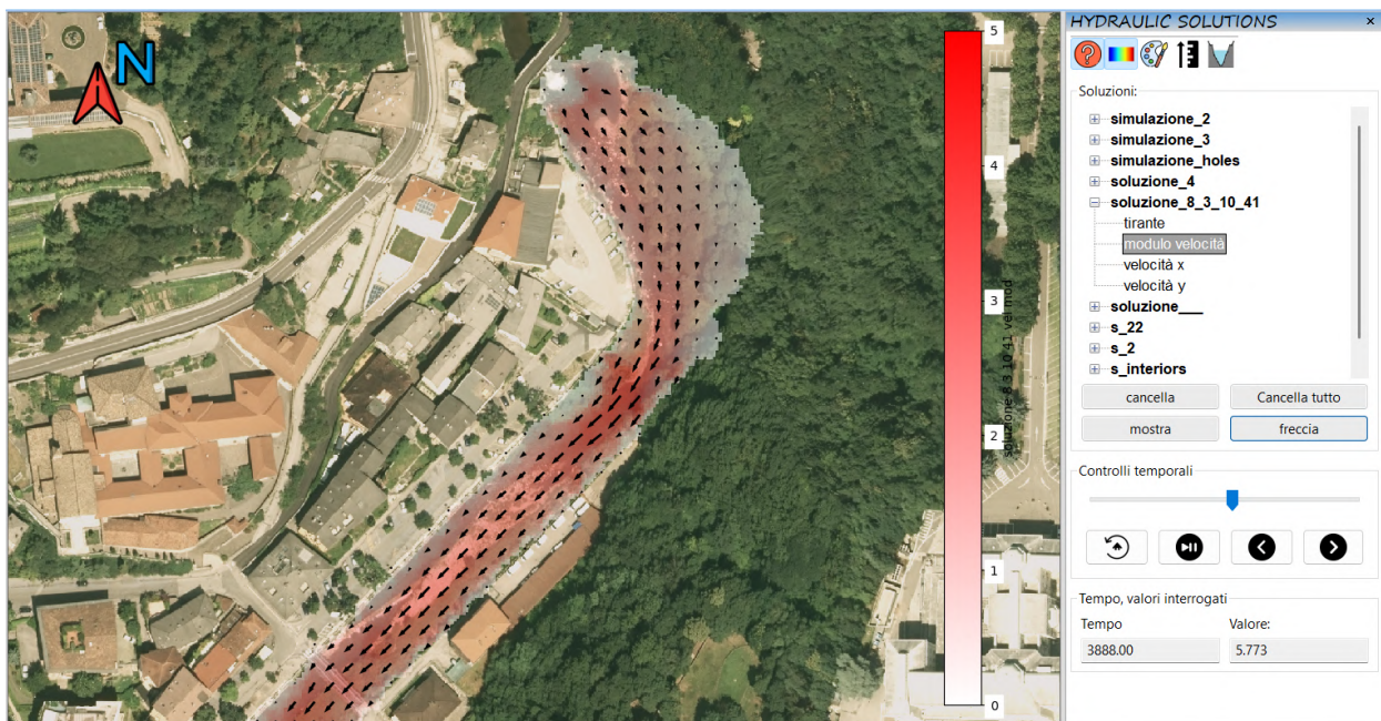
Figura 59: Inizio del tratto cittadino del torrente Fersina. Sono rappresentati il modulo della velocità e le frecce di flusso
